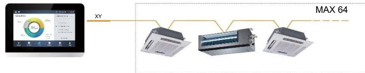
Figura 7(b). Conexión del controlador central a la unidad interior (1a. generación de AC/DC IDU)
